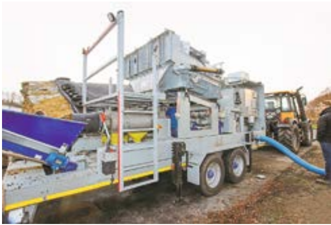
Silcon V2S-Separator: In der sechseckigen, auf Silentblöcken gelagerten „Schüttelbox“ erfolgt die Flüssigkeitsvorabscheidung. Ein Vakuum unterhalb des waagrecht eingebauten Siebes und Vibrationen unterstützen den Vorgang.
