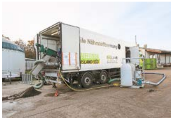
Die Zentrifuge der Raiffeisen Emsland-Süd kommt komplett in einem Sattelauflieger auf den Hof. Ein Büro und ein Stromaggregat sind ebenfalls an Bord.
