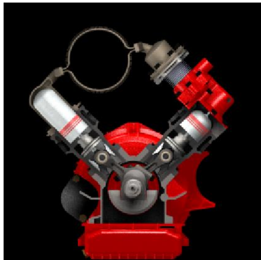
Bild 6.1: Schnittbild eines Stirlingmotors mit den Zylindern zur Kompression und Entspannung des Arbeitsmediums (Quelle: Steinborn)
