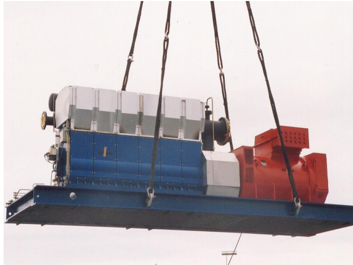
Bild 3.1: Dampfmotor (Sechszylinderaggregat mit einer Leistung von 1,1 \text{ MW}_{\text{el}} , 6 \text{ MW}_{\text{th}} ) (Quelle: Spilling)
